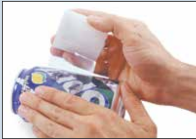
La cinta 169PPA es perfecta para levantar impresiones latentes reveladas en superficies curvas o irregulares.
