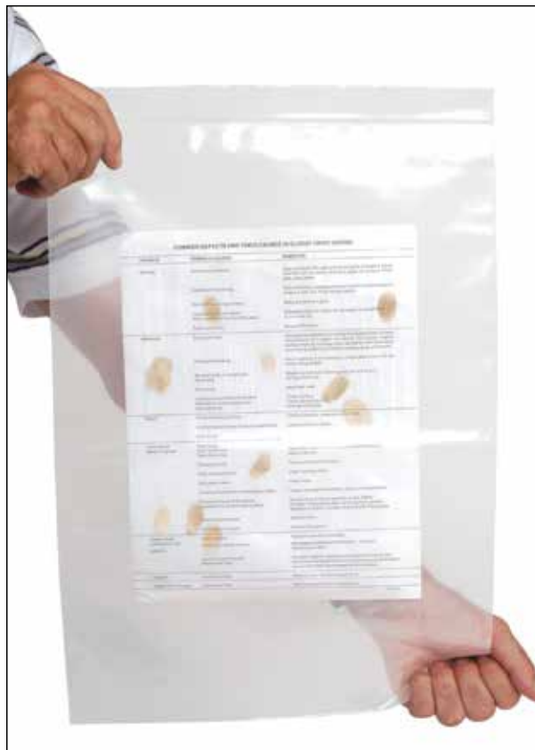
Si coloca las ampollas Iodette dentro de una bolsa de plástico, se genera una cámara de vaporización instantánea.
