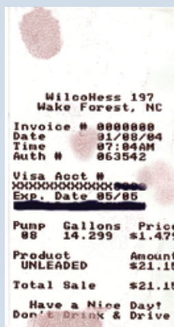
Revelado de impresiones realizado con el rociador NHT609 en un ticket de compra de combustible.
