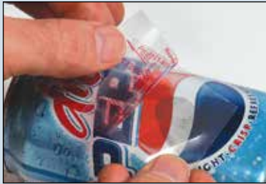
En la imagen, un técnico utiliza Lift-o-Tabs™ para levantar impresiones sobre una lata de bebida gaseosa.
