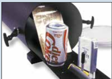
La evidencia se coloca sobre la bandeja para objetos varios de CYANOVAC y se inserta dentro de la cámara para su vaporización.
