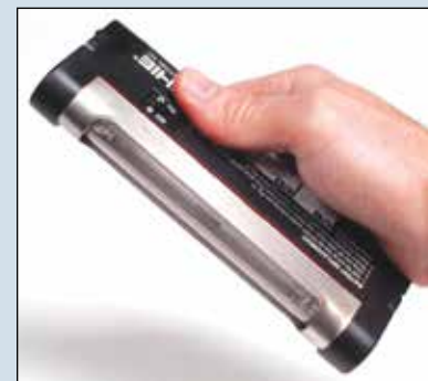
La Lámpara SNA4 revela rápidamente impresiones latentes tratadas con nitrato de plata.
