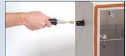
El CYANOWAND™ SCW100 y el humidificador PUM100A se conectarán al puerto de entrada superior izquierdo.
