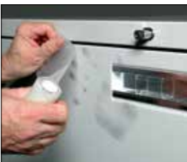
En la imagen, la cinta 145L4 se utiliza para levantar la impresión de una palma sobre un archivador.
