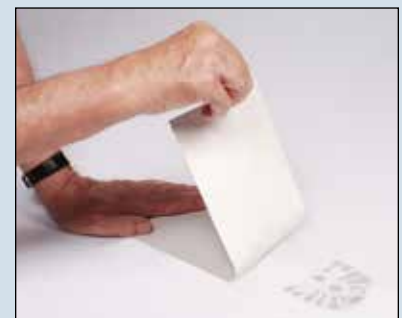
Técnico levantando una impresión de pisada con GELifter™ blanco GLT401W.
