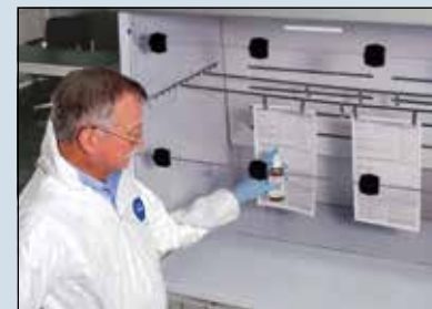
Generalmente el DFO produce impresiones latentes visibles como las que aparecen arriba, utilizando la estación de trabajo forense Núm. AC632.
