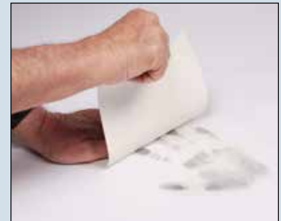
Técnico levantando la impresión de una palma de mano con el levantador de impresiones de palmas/ agrupamientos GEL blanco 125LW
