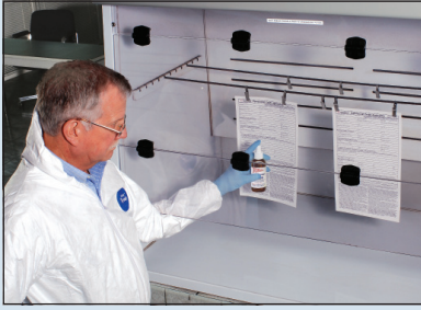
سوف ينتج مركب DFO غالبًا بصمات خفية مرئية كما هو موضح أعلاه باستخدام محطة العمل الجنائية AC632.
