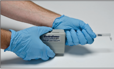
وعند التبخير بهذه الوحدة، يجب إحماء مسدس تبخير اليود عن طريق إمساكه في راحة يدك.
