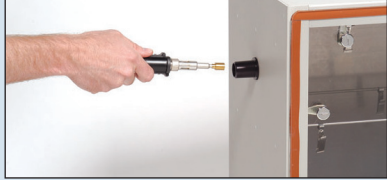
تسمح فتحة الدخول اليسرى العلوية باستيعاب جهاز Cyanowand™ رقم SCW100 والمرطب المحمول PUM100A.
