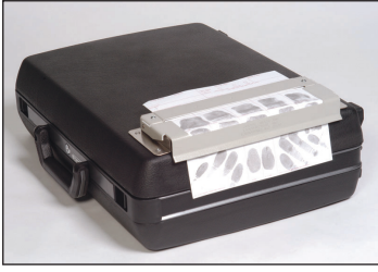
وتعمل علبة الطقم الميداني المخصصة لجميع الأغراض كسطح منضدة، ومنصة للبصمات.
