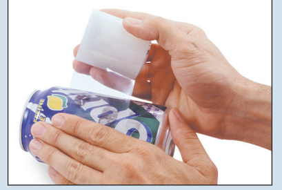
رقم 169PPA مثالي لرفع البصمات الخفية التي تم إظهارها من الأسطح المنحنية أو غير المنتظمة.
