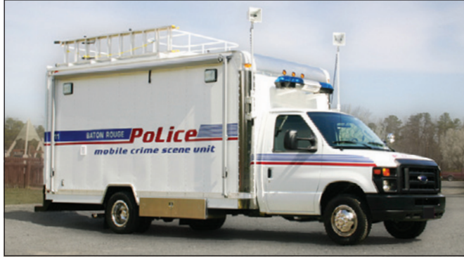
الطراز MCL900/16 مجهز بفتحة سقف اختيارية للمراقبة، وكشافات تلسكوبية، ومظلات (تندات) وصناديق تخزين خارجية.
