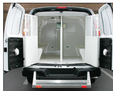
Puerta de seguridad interior simple estándar, que se muestra con puertas dobles opcionales.
