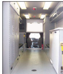
Piso en declive en "V" con desagües
