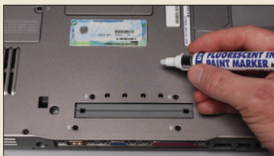
Las marcas realizadas con el marcador No. TDTUV100 son invisibles con luz normal.
