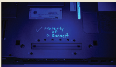
Las marcas realizadas con el marcador No. TDTUV100 son visibles con luz ultravioleta fluorescente.
