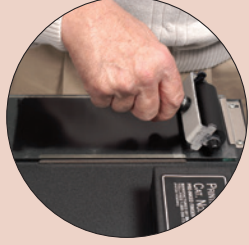
الخطوة ١: يتم وضع الحبر على اللوح باستخدام رقم PIP100.
