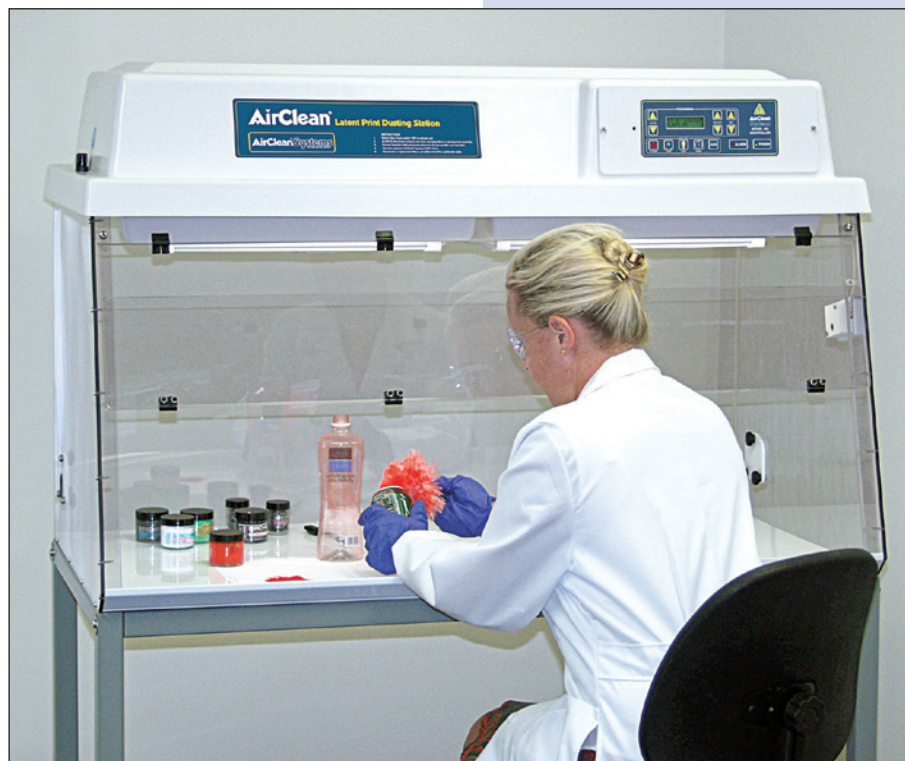
Imagen de la estación de trabajo para empolvado de impresiones latentes modelo DS200.
