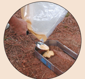
الخطوة ٤: صب مادة صنع القوالب المخلوطة على الأثر* (* الملحقات الاختيارية معروضة).
