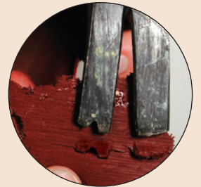
٤. بعد تفشير القالب من السطح، قم بمقارنته مع الأداة المشتبه بها.
