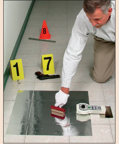
جهاز نموذجي لرفع الأثار من الغبار باستخدام ESP900 على سطح أفقي.
