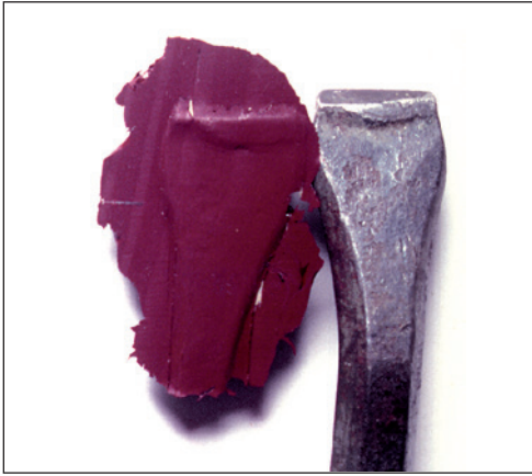
تستخدم مادة MIKROSIL™ لصب اقتحام لياح حيث استخدمت عتلة للدخول.
