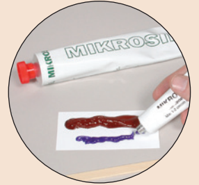
١. قم بقياس أطوال الأساس والمادة الحفازة. (لاحظ أن المادة الحفازة أقصر بعض الشيء من الأساس).
