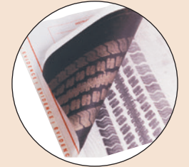
٢. ينقل ضغط الإطار تحت الحمل مادة الكربون إلى الورقة المغطاة باللاصق. فقط انزع ورقة الكربون وتخلص منها.
