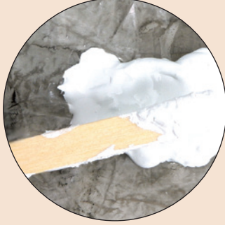
٢. يتم خلط مركب الرفع ووضعه على الآثار الخفية. وانتظر ١٠ - ١٥ دقيقة للتجهيز.
