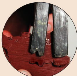
4. Después de desprender el molde de la superficie, compárelo con la herramienta sospechosa.
