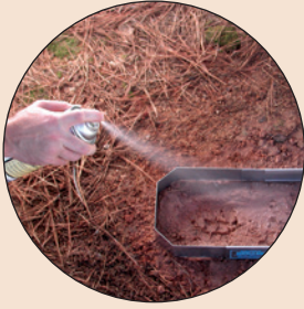
PASO 1: Prepare la impresión con el endurecedor de tierra y polvo 638CA*.
