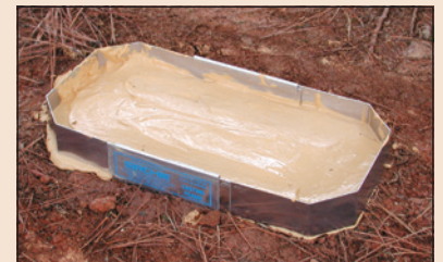
Un molde hecho con material para moldes HARD-CORE BLUE™ se cura por completo en aproximadamente 30 a 45 minutos.
