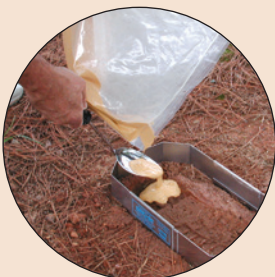
PASO 4: Vierta la mezcla del material para moldes en la impresión*. (* Se ilustran accesorios opcionales).
