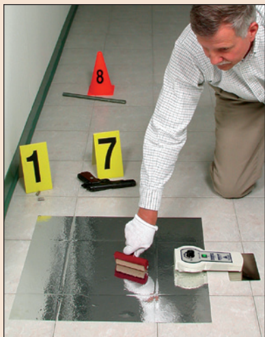
Esquema típico para levantamiento de impresiones de polvo con el equipo No. ESP900 sobre una superficie horizontal.
