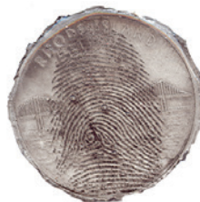
La impresión latente cubierta de polvo que se observa en la moneda de un cuarto de dólar se recupera con el más mínimo detalle.
