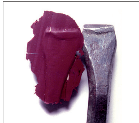
MIKROSIL™ utilizado para tomar el molde del marco de una puerta forzada con una palanca para abrirla
