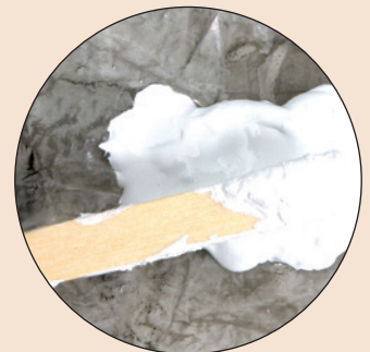
2. El compuesto para levantamiento se mezcla y se aplica a la impresión latente. Deje transcurrir 10 a 15 minutos para el fraguado.
