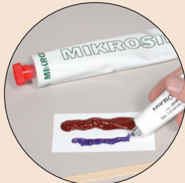
1. Mida las longitudes de la base y el catalizador. (Observe que la porción de catalizador es ligeramente más corta que la de la base).
