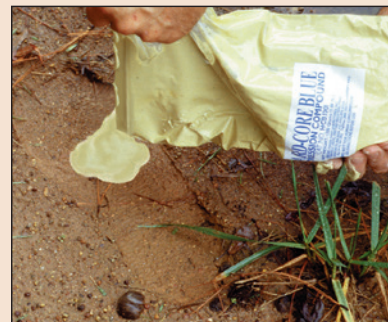
Se vierte HARD-CORE BLUE™ en la superficie para realizar un molde de la impresión.
