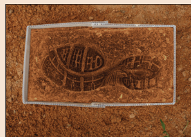
Los bastidores descartables pueden ajustarse para adaptarlos a las impresiones del zapato variando la posición de las dos piezas COREX.
