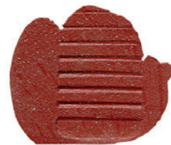
Molde de una marca de herramienta (izquierda) en la parte trasera de un trozo de madera realizado con el compuesto marrón No. PVS200.
