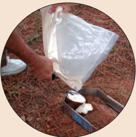
PASO 4: Vierta en la impresión*. (* Se ilustran accesorios opcionales).
