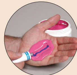
3. Aplique una línea de catalizador del tamaño de la muesca y mezcle totalmente con la mano.
