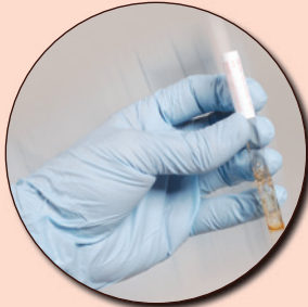
٣. رَج برفق ثم قارن التفاعل باللوحة التوضيحية للألوان المقدمة داخل الطقم.
