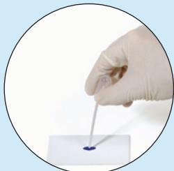
3. El reactivo 290P2 se pondrá de color azul o negro si las pruebas de material sospechoso son positivas.
