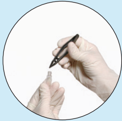
1. Se agrega un grano del material sospechoso en un frasco de retención de muestras.
