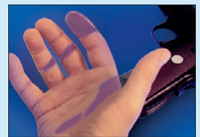
Después de la aplicación del reactivo y de la exposición a la luz ultravioleta de onda corta, se detecta la traza de metales.
