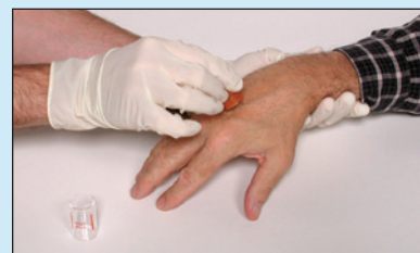
El técnico recolecta los residuos para la prueba por microscopio electrónico de barrido.
