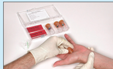
El técnico recolecta los residuos para la prueba por microscopio electrónico de barrido.
