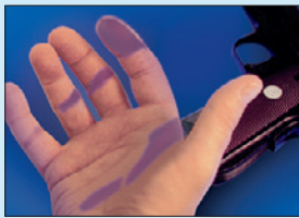
بعد استخدام الكاشف والتعرض للأشعة فوق البنفسجية قصيرة الموجة، يتم اكتشاف الأثر المعدني.
