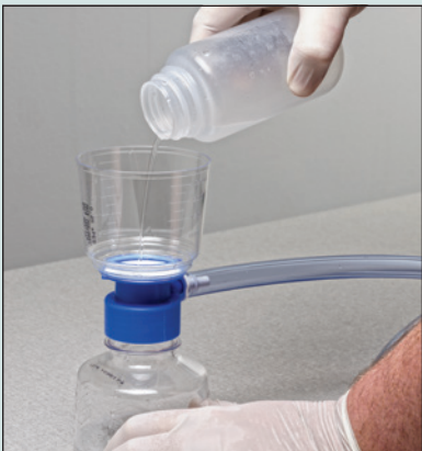
Después de recorrer la zona de interés buscando muestras de ADN, verter la solución tampón recolectada a través del filtro, sellar el filtro en la bolsa con respiración provista con la cinta de integridad y enviar al laboratorio para su análisis.
