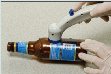
El M-VAC permite recolectar ADN de superficies no porosas que fueron tocadas.
