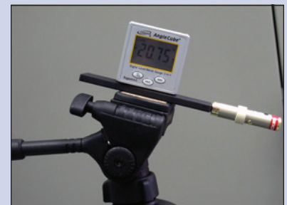
قياس زاوية مسار المقذوف باستخدام مقياس الزوايا الرقمي DMANGLE ووحدة ليزر مثبتة على الحامل الثلاثي باستخدام وحدة التوصيل بالحامل
