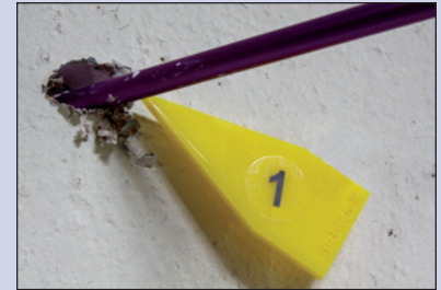
قضيب إدخال، وعلامة خديد Sirchie™ مثبتة بعلامة Stikki Dot لتحديد المكان وزاوية الدخول
