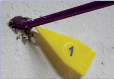
Varilla de penetración y marcador SirchMark™ sostenidos por el Stikki Dot para identificar el lugar y el ángulo de entrada.
