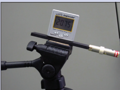
Medición del ángulo de trayectoria con buscador digital de ángulo DMANGLE y láser montados sobre trípode utilizando el adaptador del trípode.
