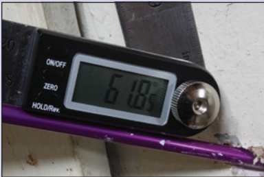
Medición del ángulo de entrada con transportador digital No. DRP10.
