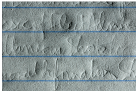
Luz blanca indirecta utilizada con una cámara réflex digital con lentes de aproximación para macrofotografía de escritura indentada. (No incluye la cámara).
