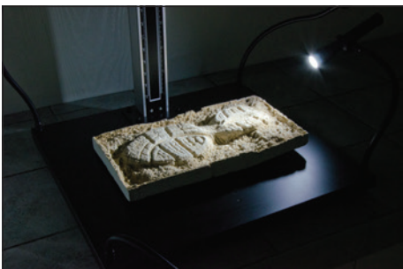
Se puede fotografiar artículos de evidencia más grandes, como ser moldes de pisadas, elevando el soporte de la cámara mediante el ajuste de la columna. Se puede tomar la fotografía utilizando luz blanca desde un ángulo indirecto. (No incluye la cámara).
