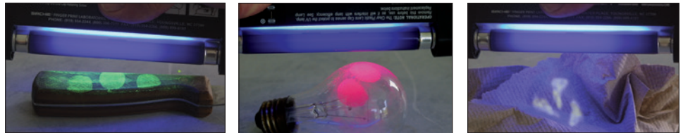
يعتبر مصدر الإضاءة CUV100T مفيداً في اكتشاف السرقة عند مشاهدة البقع والمساحيق والمعاجين غير المرئية في مسرح الجريمة.
