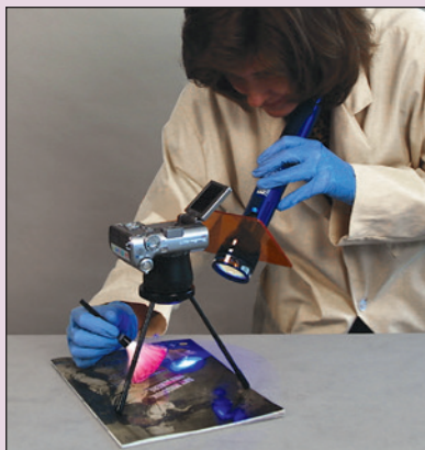
El técnico utiliza el equipo BM300 para facilitar la fotografía de impresiones latentes acentuadas en la portada de una revista.
