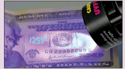
La unidad No. UVFT100 se emplea para detectar marcas invisibles en los billetes.
