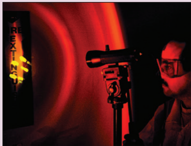
Utilice los anteojos y las gafas con filtro de barrera para ver los restos de evidencia con fuentes alternativas de luz forense.
