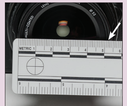
Medición del tamaño de la rosca del filtro: Las roscas de los filtros se miden en milímetros, así que use una regleta métrica. Coloque la regleta cruzando el diámetro (la sección más ancha) de la lente de la cámara, como se ilustra, comenzando desde el borde interior de la rosca del filtro y mida hasta el lado opuesto.
