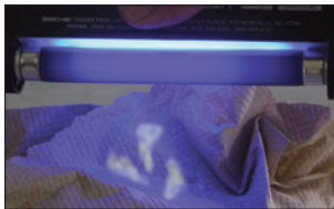
La fuente de luz CUV100T es útil para la detección de robos por visualizar manchas invisibles, polvos y pastas en la escena del crimen.
