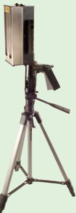
Modelo No. KSSPG utilizado para colocar una fuente de luz ultravioleta de onda corta en un trípode.
