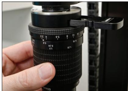
*Ajuste minuciosamente el foco y configure la apertura focal para lograr una exposición precisa con las ópticas de alta calidad del reproductor Labkam.*
