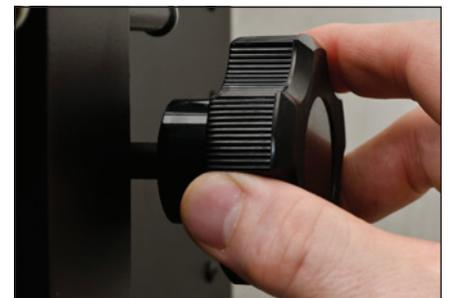
*Aumente o disminuya con precisión la distancia de la lente al objeto utilizando la rueda de ajuste de altura en la columna.*
